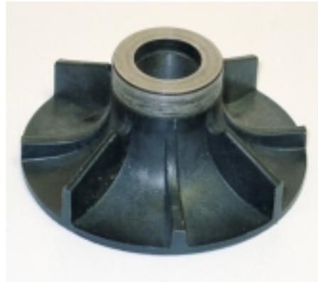
насосов должна обеспечивать высокую производительность по антифризу, а также быть технологичной и нематериалоемкой. Кроме того, в данном узле водяного насоса конструктивно должны предусматриваться меры против кавитации и возможности перегрева крыльчатки из полипропилена (выше 160 °С) при нештатной ситуации работы насоса без антифриза или с недостаточным его количеством (т.е. в условиях «сухого трения»).
