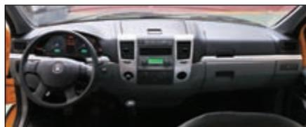
Фото 1. Панель приборов автомобиля «Газель-Бизнес» из материала «Армлен ПП ТМ 20-5УП» (все фото: «Полипластик»)
