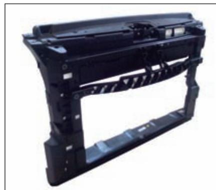
Фото 5. Монтажная рама автомобиля WV-Polo из материала «Армлен PP GF 30-5HS»
